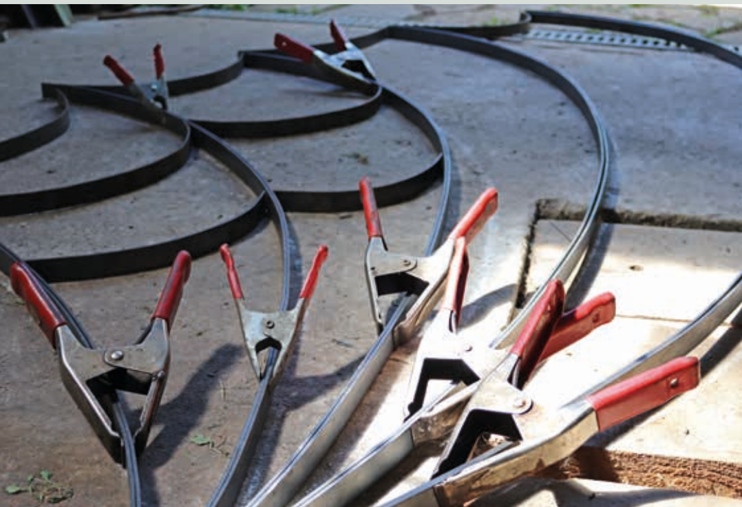
Formfindung für die Drachenflügel in Rund- und Flachstahl.
